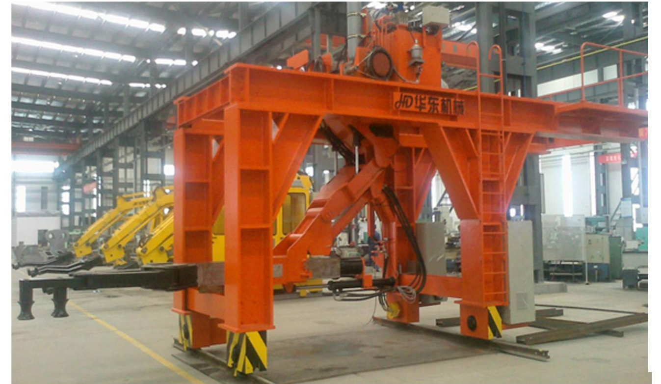
轨道式重载机器人(轨道悬空)the manipulator walking on the track（the track in the air）
