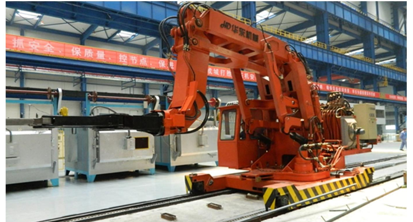
轨道式重载机器人（轨道置于地面）the manipulator walking on the track（the track on the ground）
